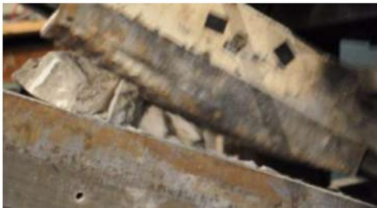
Рисунок 3 - Состояние кусков материала в зоне дробления
